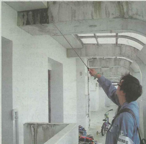
外壁の打診検査。コンクリートや塗装の浮きといった劣化症状が出ていないかを、棒でたたいて確認する(建物診断設計事業協同組合沖縄県支部提供)
